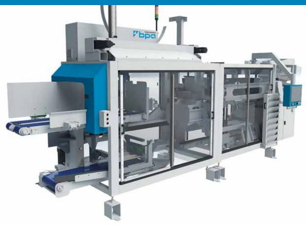
Unsere Cubemaster Serie wurde ursprünglich für die spezielle vertikale Verpackung von gefrorenen Pommes Frites entwickelt. Die vertikale Verpackung reduziert den Bruch der Pommes Frites während des Transports und verteilt diesen zudem gleichmäßig auf alle Beutel im Karton. Dies bedeutet allgemein geringere Abfallmengen im Herstellungsprozess von Pommes Frites.
