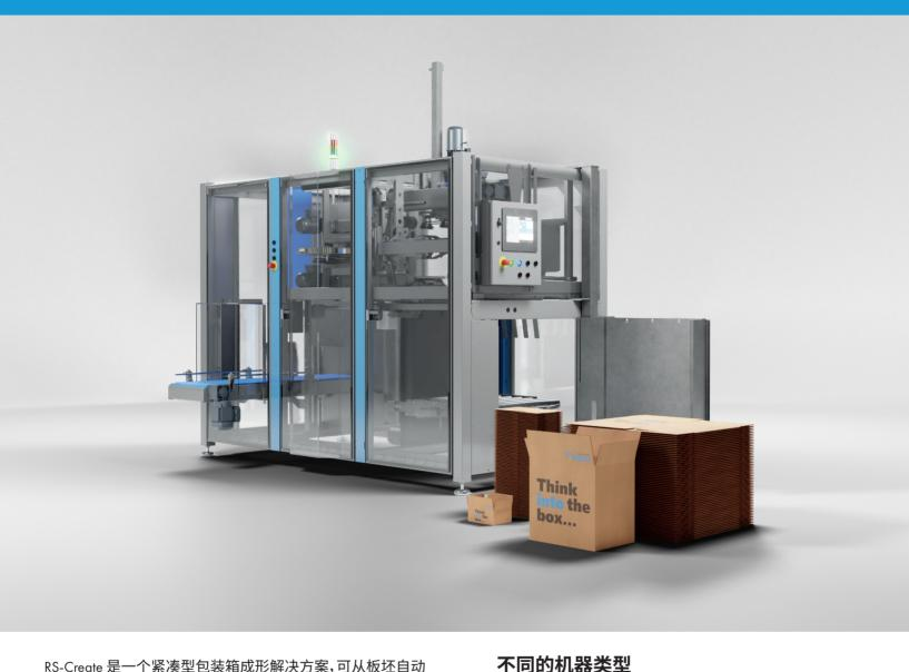
RS-Create 是一个紧凑型包装箱成形解决方案,可从板坯自动 成形、折叠和密封瓦楞纸盒。这种高效、紧凑的RSC包装箱成形 器可根据不同的包装箱尺寸进行完全自动调整,并配有单列水 平纸板料仓,可连接到 BPA 提供的自动纸板分配系统。 RS-Create 设计简单,易于使用,不同包装箱成型器的转换实现 了完全自动化。该机器可生产90度角的理想包装箱,这对于在 托盘上实现最佳堆放效果和保护您的产品非常重要。RS-Create 系列设备可以轻松集成到新的或现有的 BPA 包装箱生产线, 或任何其他现有的包装线中。
